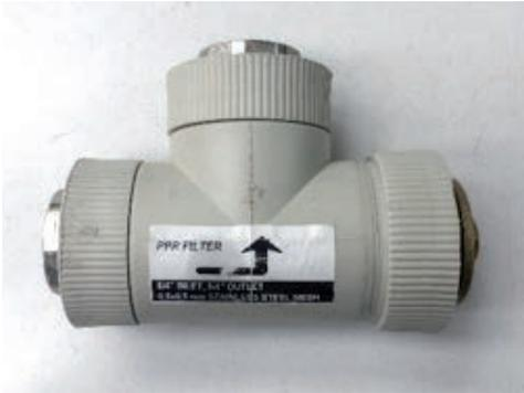
*Filtre à positionner à l'horizontale, équipé d'un bouchon sur le côté droit qui sert à retirer le filtre situé à l'intérieur.*
